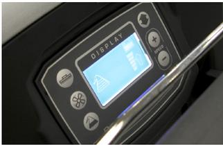
Panneau de commande analogique simple et intuitif. Levier de commande d'actionnement de la brosse et distribution de la solution de nettoyage. Interrupteur ON/OFF et interrupteur à clé pour l'extinction des batteries, interrupteur moteur brosse et aspiration, système de réglage du détergent.
